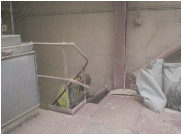
Figura 5.3 - Scaletta impolverata nella sala del frangitore; (HSE, 2010)
